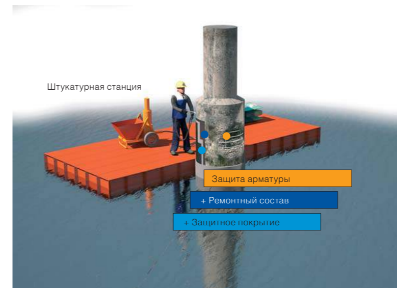
Ремонт надводной части
