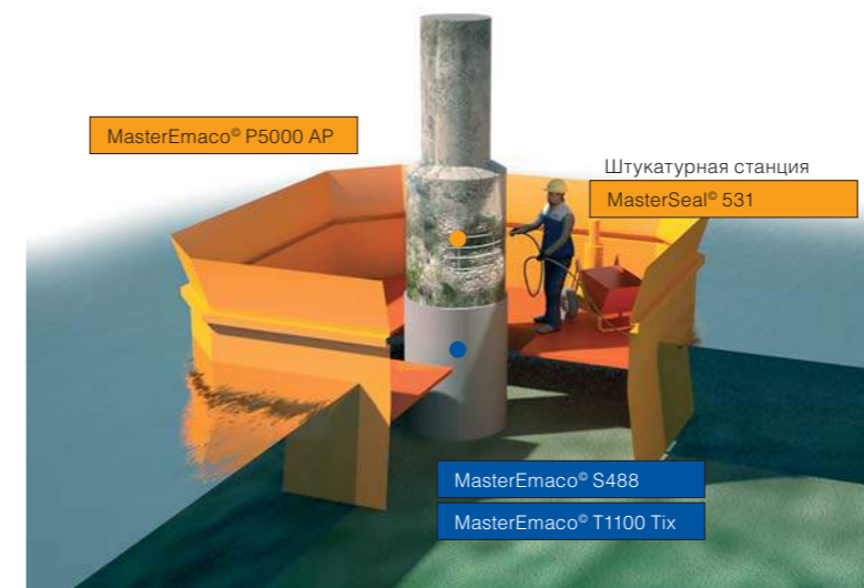
Ремонт с применением кессона, оштукатуривание
