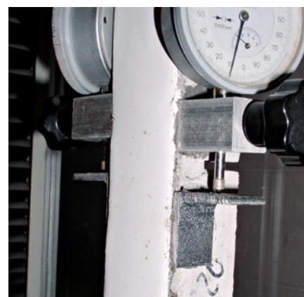
Динамическое испытание перекрытия трещин согласно стандарту EN 1062-7 (метод В)
